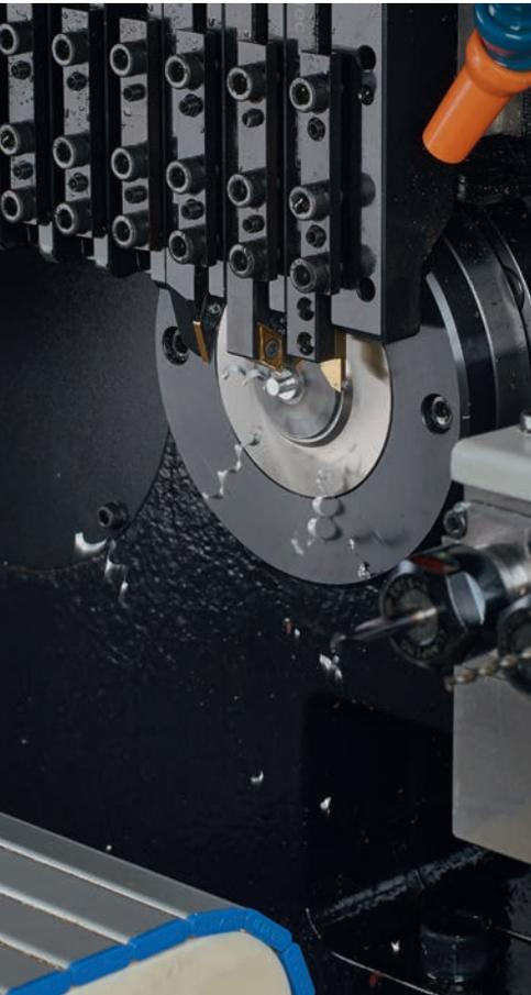
Das System Active Chip Breaker von Tornos (ACB) ist eine neue universell einsetzbare und höchst effiziente Schneidtechnologie, mit der Werkstücke mit nahezu beliebiger Geometrie aus den verschiedensten Werkstoffen bearbeitet werden können. Die Späne werden kontrolliert gebrochen. Dadurch wird ein Ausfall der Maschine aufgrund einer Anhäufung von Spänen verhindert. Lernen Sie schon jetzt diese Technologie kennen.
