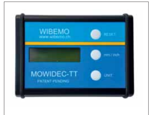
不能再简单了：该画面表示了最接近微米的直径画面，然后对该误差做偏移补偿，其过程简单易行。重新定位主轴可不就是一件儿戏！
