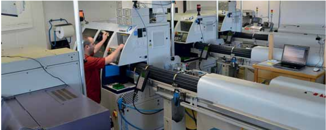
在配置Deco 10的车间内，机床在温控环境中每天工作18个小时，每周工作六天。达到 \pm 2 \mu 的公差要求是一件平常的事情。
