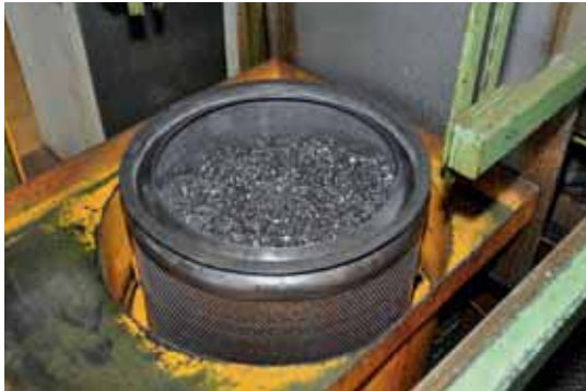
L'huile de coupe Motorex Ortho NF-X est très peu volatile et est facile à séparer des copeaux. Cela permet de réduire au minimum les dégagements d'huile et les opérations d'appoint en huile neuve s'en trouvent espacées.
